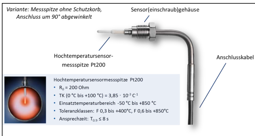
Abbildung 8: Hochtemperaturfühler mit keramischer Messspitze bis +850°C mit geringer Ansprechzeit für Abgas- und Motormanagement (Automotive) – Konfektionierungsbeispiel
