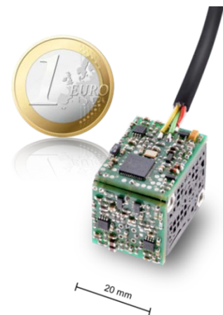
Abbildung 11: VOC/CO 2 -Sensor - Demonstrator (B x L x H: ca. 30 x 20 x 25 mm)
